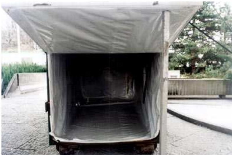
Fot. 3. Kontener do przewożenia odpadów azbestowych wyłożony folią PE (źródło: www.algader.pl )
