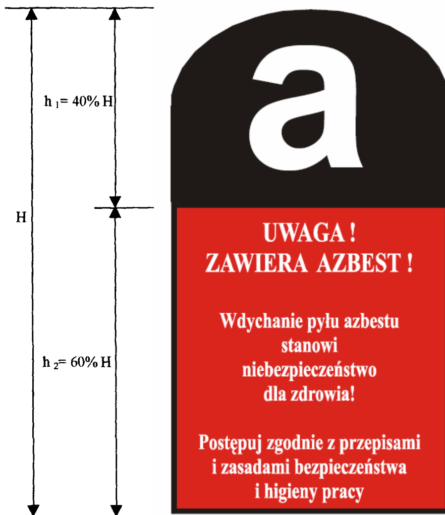
Ryc. 1. Oznakowania wyrobów zawierających azbest.
